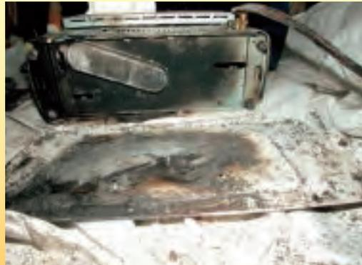
※ストーブ底面と置台の燃焼状況
